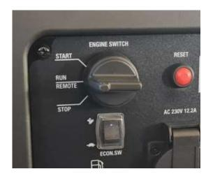
Drucktaster muss gedrückt bleiben und den Engine Switch Schalter auf RUN stellen
