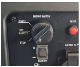
Den Engine Switch Schalter auf STOP stellen. Die Programmierung ist abgeschlossen.
