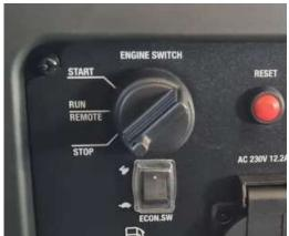
Stellen Sie den Engine Switch Schalter auf STOP
