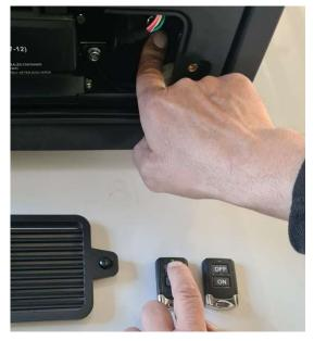
Drucktaster immer noch gedrückt halten. Fernbedienung auf ON und innerhalb 2 Sekunden auf OFF drücken.
