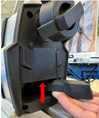
Den verstellbaren Spannhebel nach oben drücken, bis dieser aus der unteren Verzahnung entriegelt ist.
