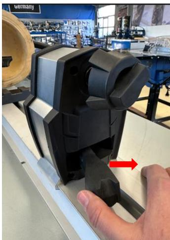
Den Spannhebel nach rechts schieben und überprüfen, ob der Reitstock auf dem Maschinenbett fest verklemmt ist.
