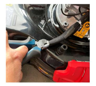
Schneiden Sie die beiden Kabelbinder vom Kabelbaum auf und schieben die die Schutztülle nach oben
