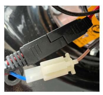
Überprüfen Sie auch diese Steckverbindung, möglicherweise hat sich diese gelockert.
