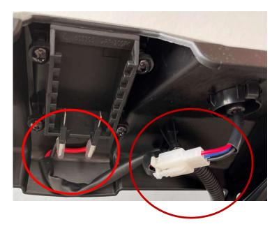
Überprüfen Sie die Steckverbindungen, möglicherweise hat sich eine gelockert.
