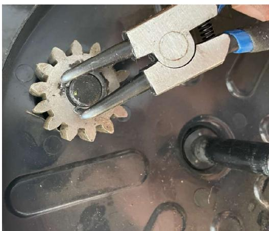
Zahnrad aufstecken und mit dem Sicherungsring sichern.
