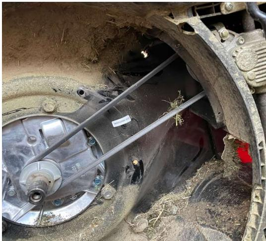
Legen Sie den Keilriemen auf die Riemenscheiben vom Radantrieb auf und drehen diesen auf die Motorriemenscheibe auf.
