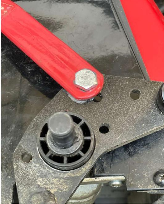
Schrauben Sie den Bügel der Höhenverstellung mit der Bundschraube an die Radachse fest.
