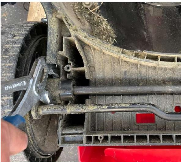
Die Radachse ins Gehäuse einlegen und die Kunststoffbuchsen mit einer Zange drehen sodass die Nut mittig ist.
