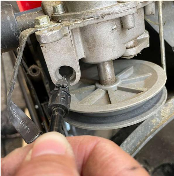
Den Clips vom Bowdenzug am Radantrieb einhängen.
