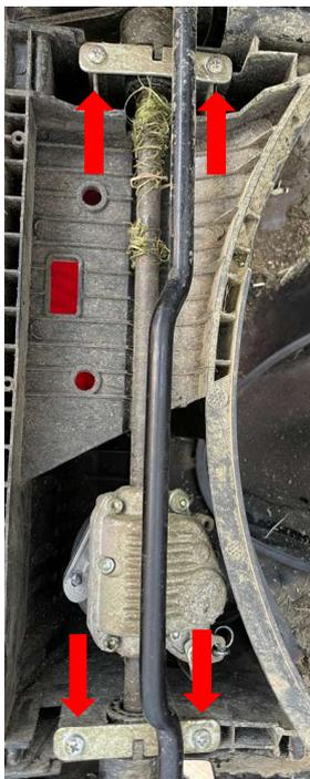
Schrauben Sie die vier Schrauben von der Radachsenbefestigung ab und nehmen die Befestigungsplatten ab.
