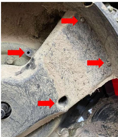
Die vier Schrauben von der Riemenabdeckung abschrauben und die Abdeckung abnehmen
