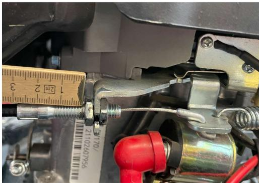
Den Bowdenzug einhängen und stellen Sie das Maß ein, welches Sie beim Ausbau abgemessen haben. Sichern Sie die Einstellung mit der Kontermutter.
