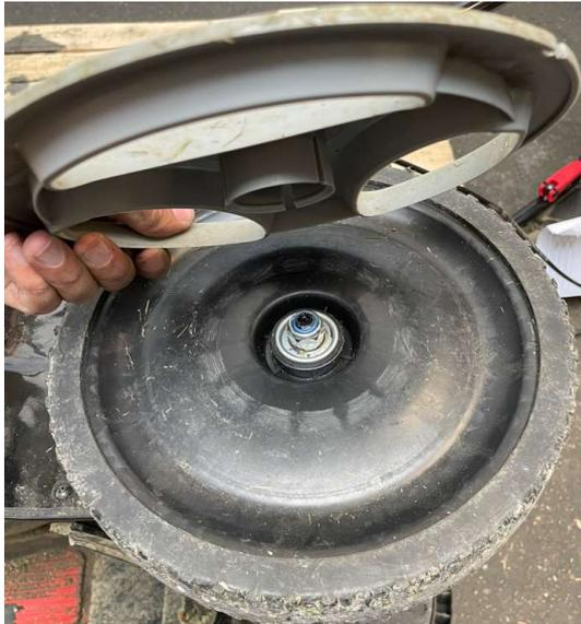
Rad mit der Sicherungsmutter befestigen und die Radabdeckung aufstecken.
