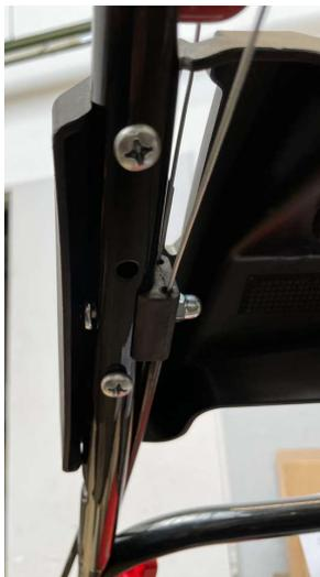
Schrauben Sie beide Linsenschrauben auf und entfernen Sie die Hutmutter von der Halterung für die Bowdenzüge
