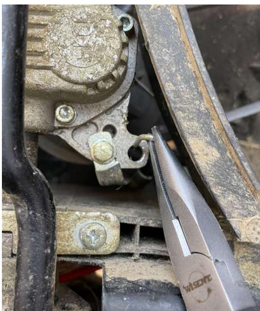
Hängen Sie die Zugfeder am Radgetriebe ein.
