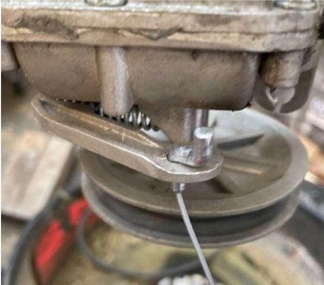
Den neuen Bowdenzug durch das Gehäuse einfädeln und den Z-Haken am Radgetriebe einhängen.
