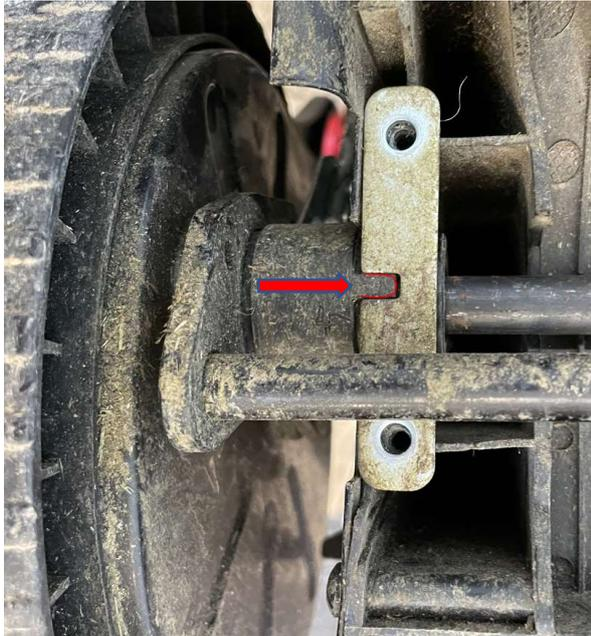
Auf beiden Seiten die Befestigungsplatten in die Nut von der Kunststoffbuchse einlegen und festschrauben.
