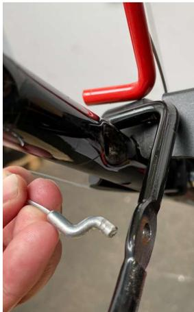
Hängen Sie beide Z-Haken vom Bowdenzug an den Hebeln aus
