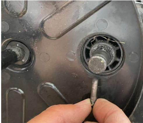
Den Stift aus der Achse ziehen und die innere Radabdeckung abnehmen
