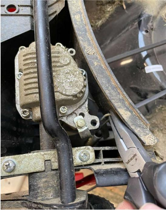
Hängen Sie die Feder vom Radantrieb aus und drehen Sie den Keilriemen von der Riemenscheibe herunter
