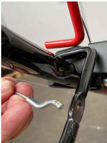
Hängen Sie beide Z-Haken vom Bowdenzug an den Hebeln aus
