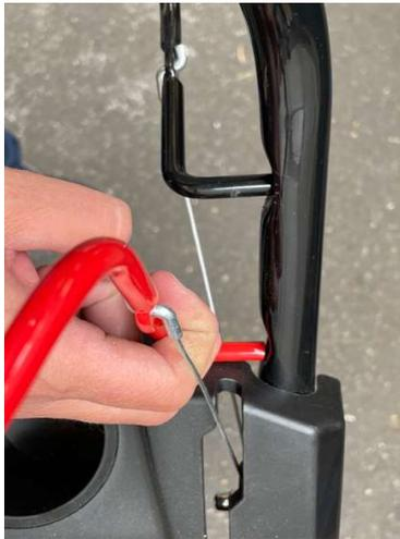
Ziehen Sie den Motorbremshebel und den Radantriebshebel aus dem Gestellholm
