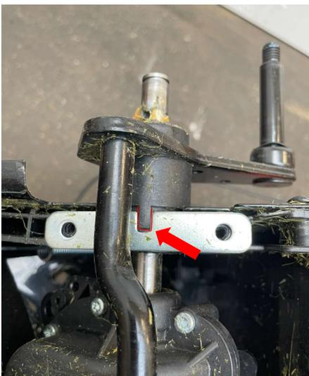
Auf beiden Seiten die Befestigungsplatten in die Nut von der Kunststoffbuchse einlegen und festschrauben.
