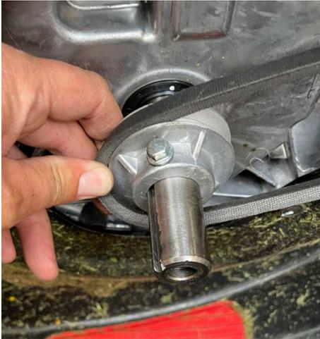
Legen Sie den Keilriemen auf die Riemenscheiben vom Radantrieb auf und drehen diesen auf die Motorriemenscheibe auf.
