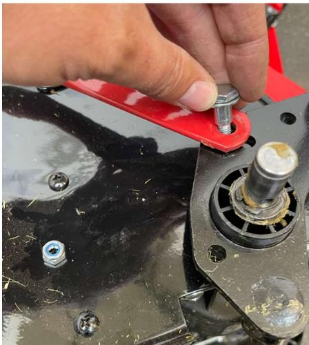
Schrauben Sie den Bügel der Höhenverstellung mit der Bundschraube an die Radachse fest.
