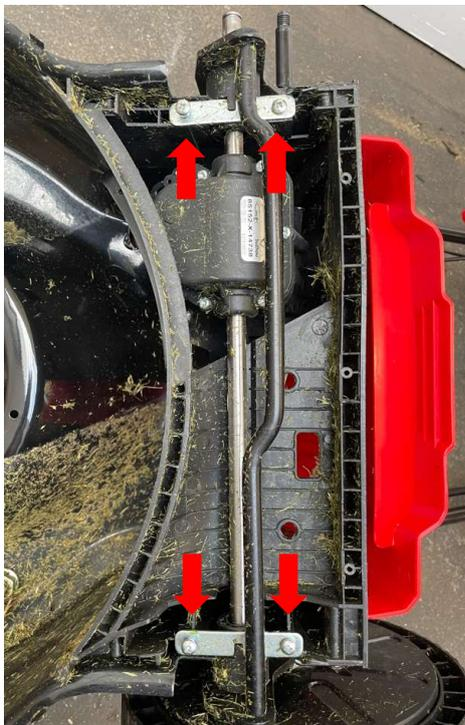
Schrauben Sie die vier Schrauben von der Radachsenbefestigung ab und nehmen die Befestigungsplatten ab.
