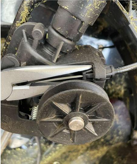
Den Clips vom Bowdenzug mit einer Zange zusammendrücken und ausfädeln und komplett aus dem Gehäuse ziehen.
