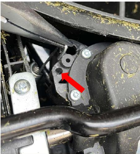
Hängen Sie die Zugfeder am Radgetriebe ein.
