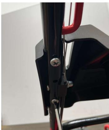
Schrauben Sie beide Linsenschrauben auf und entfernen Sie die Hutmutter von der Halterung für die Bowdenzüge
