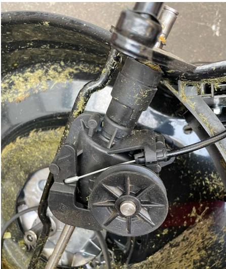
Den neuen Bowdenzug durch das Gehäuse einfädeln und den Z-Haken am Radgetriebe einhängen.
