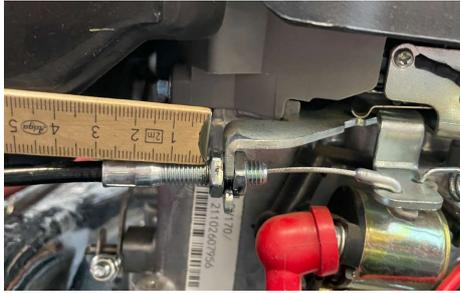
Messen Sie das Maß zwischen Kontermutter und Gewindeende, dieses Maß wird wieder beim Einbau des neuen Bowdenzugs benötigt.
