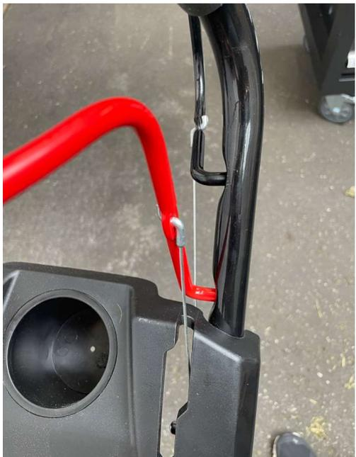
Hängen Sie die Hebel im Gestellholm wieder ein. Der rote Motorbremshebel in die unter Bohrung und den schwarzen Radantriebhebel in die obere Bohrung.
