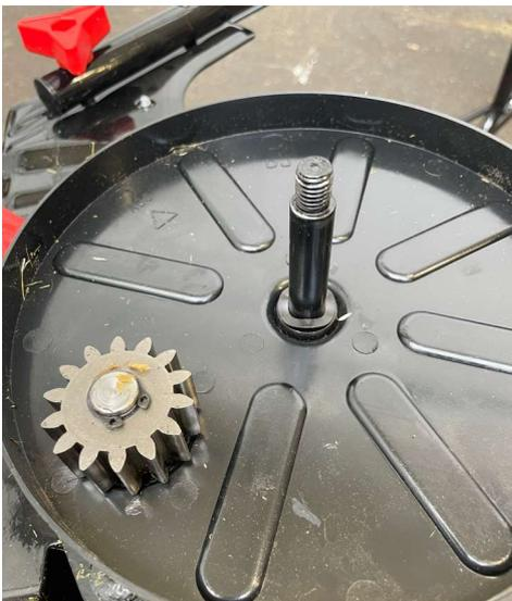
Zahnrad aufstecken und mit dem Sicherungsring sichern.
